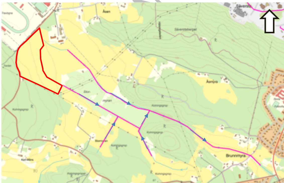
Figur 9. Markavvattningsföretagets diken (lila färg) och dess flödesriktningar (blå färg) visas, samt planområdet (röd färg).
