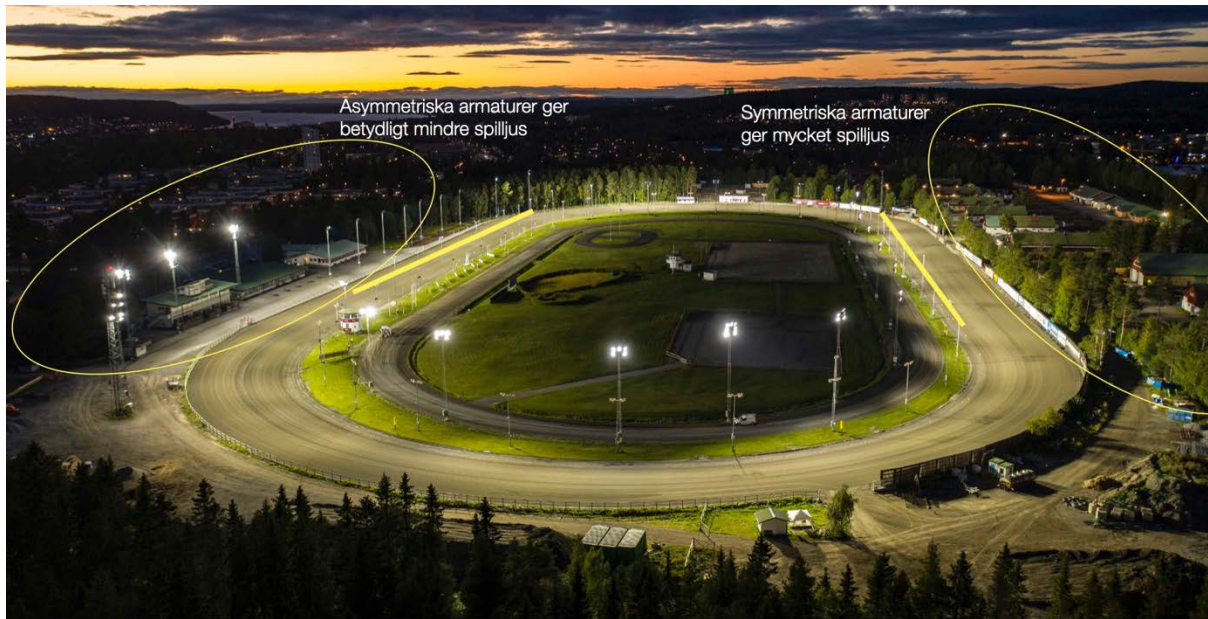
Figur 2.2 - Exempel från Östersunds Travbana Nivå2 med skillnad på spilljus mellan upploppsida och bortre långsida vid val av olika armaturtyper (asymmetrisk/symmetrisk)
