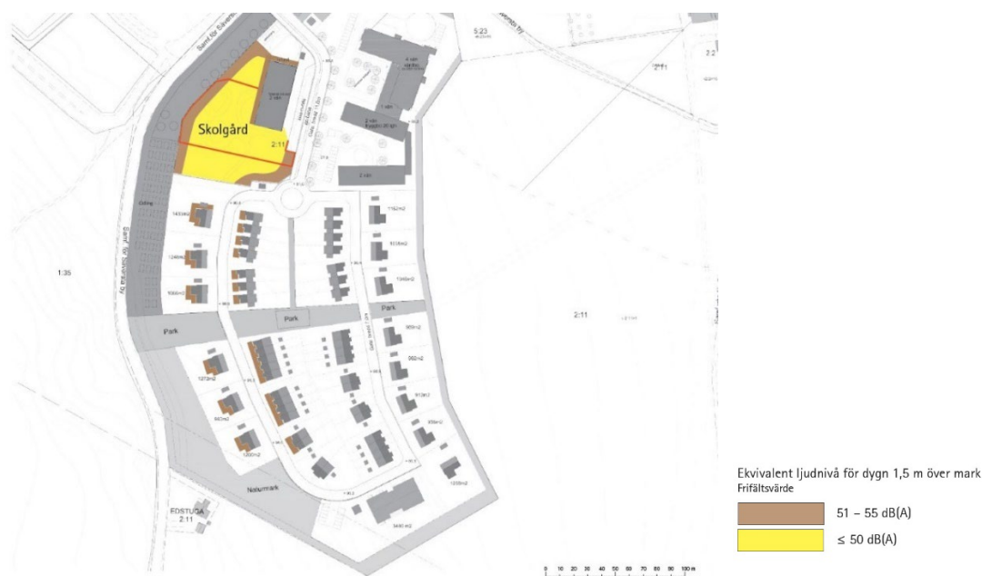
Figur 7. Kvarteret närmast Frelugavägen som möjliggör för en förskola liksom bostadsfasader närmast vägen söderut exponeras för ljudnivåer över 50 dBA; bruna markering. Källa: AH Akustik 2023-02-08.
